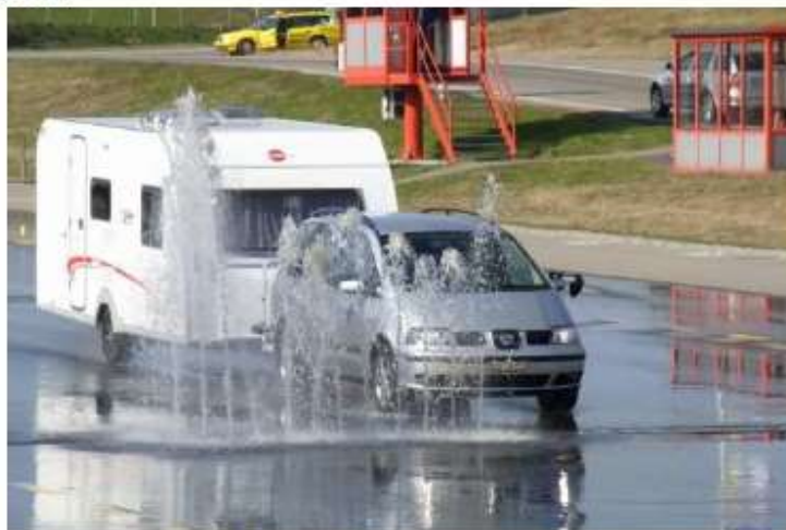
Anhängertraining: Bremsen auf Gleitbelag mit Wasserhindernissen
